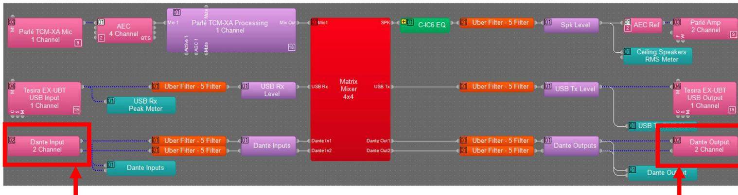
この例では2チャンネルのDanteInputコンポーネントブロックと2チャンネルのDanteOutputコンポーネントブロックが Unit:2に割り当てられています。コンフィグのコンパイルの結果は以下の通りです。
